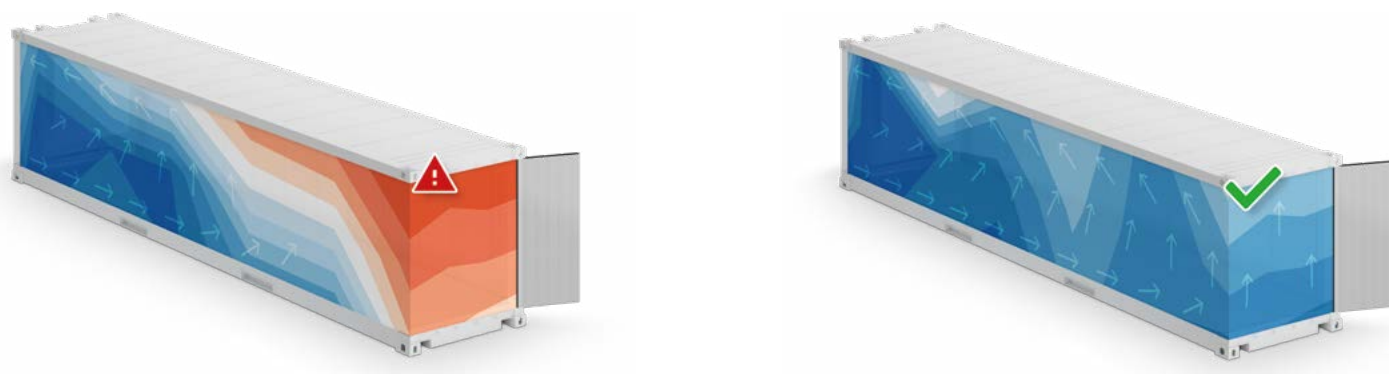
Figuur 14. De situatie in de container zonder, en met OTFLOW. Blauwe kleuren geven koele lucht aan, rode kleuren warme lucht.
